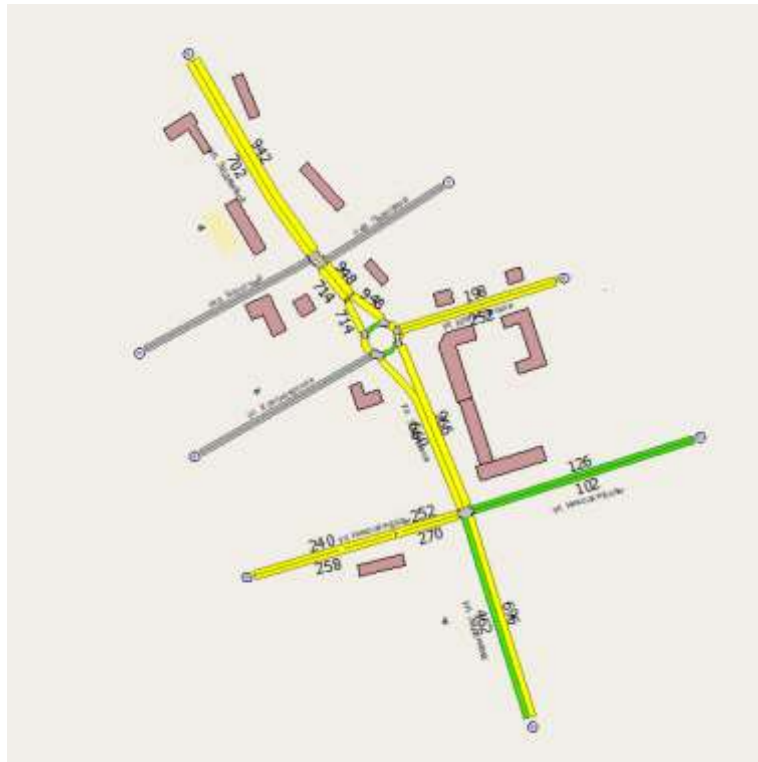
Рисунок 2.28 – Фрагмент моделирования проектной схемы ОДД узла №1 с картограммой загруженности при существующей интенсивности движения, авт./ч.
