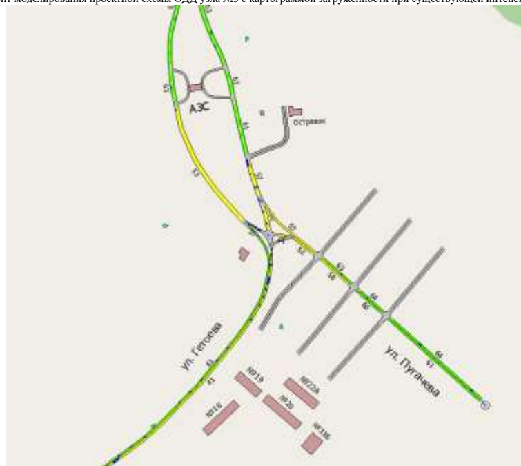
Рисунок 2.42 – Фрагмент моделирования проектной схемы ОДД узла №5 с картограммой средней скорости движения, км/ч.
