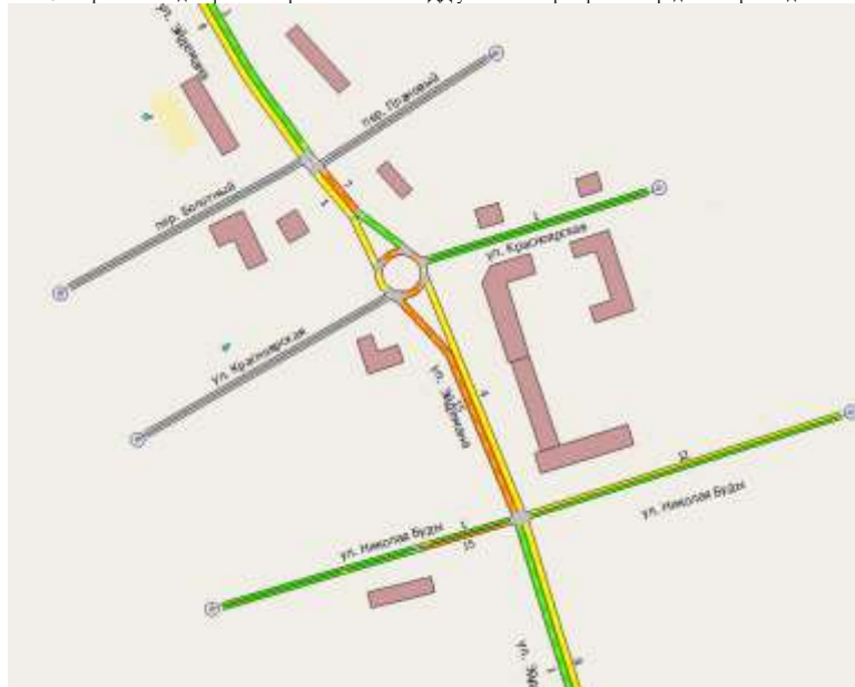
Рисунок 2.30 – Фрагмент моделирования проектной схемы ОДД узла №1 с картограммой средней временной задержки, с./км.
