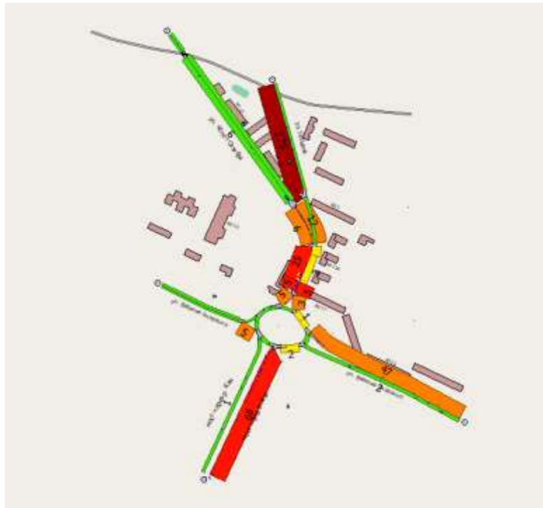
Рисунок 2.35 – Фрагмент моделирования проектной схемы ОДД узлов №2 и №3 с картограммой средней временной задержки, с./км. Сравнение основных характеристик транспортных потоков узлов №2 и №3 при существующей и проектной ситуациях представлено в таблице 2.7.
