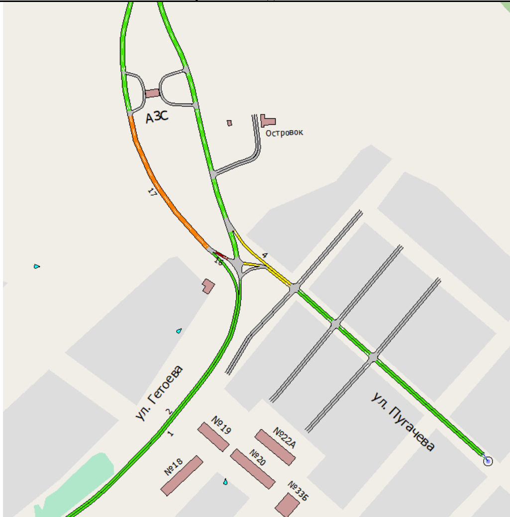
Рисунок 2.26 – Фрагмент моделирования существующей схемы ОДД узла №5 с картограммой средней временной задержки, с./км. Основные характеристики транспортных потоков узла №5, полученные при помощи программного комплекса Aimsun, указаны в таблице 2.5.
