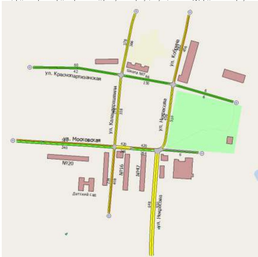
Рисунок 2.21 – Фрагмент моделирования существующей схемы ОДД узла №4 с картограммой загрузки при существующей интенсивности движения, авт./ч.
