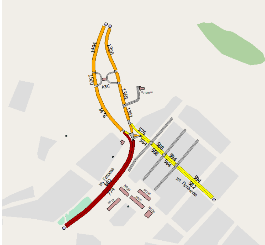
Рисунок 2.24 – Фрагмент моделирования существующей схемы ОДД узла №5 с картограммой загрузки при существующей интенсивности движения, авт./ч.
