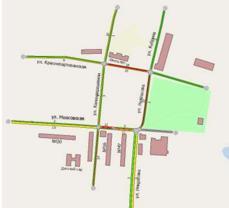
Рисунок 2.39 – Фрагмент моделирования проектной схемы ОДД узла №4 с картограммой средней временной задержки, с./км.
