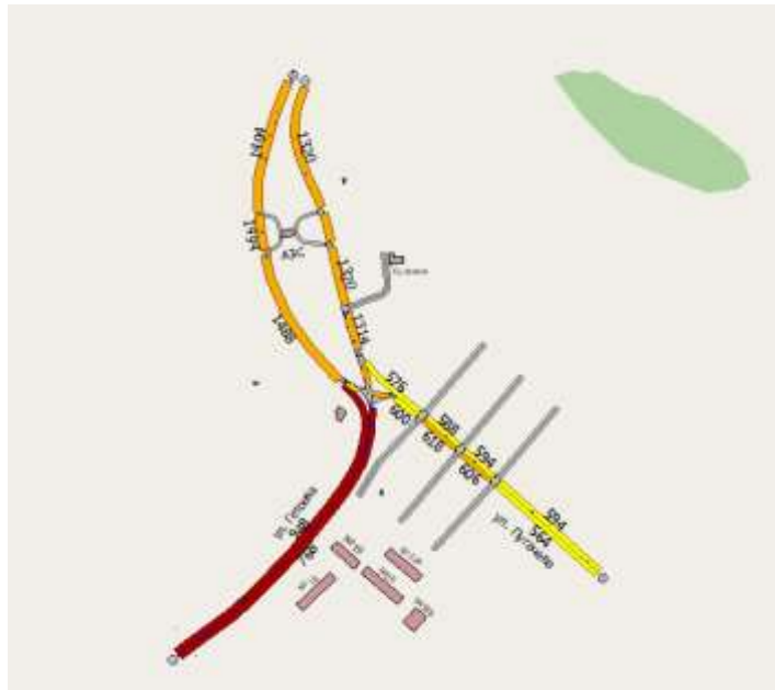
Рисунок 2.41 – Фрагмент моделирования проектной схемы ОДД узла №5 с картограммой загруженности при существующей интенсивности движения, авт./ч.
