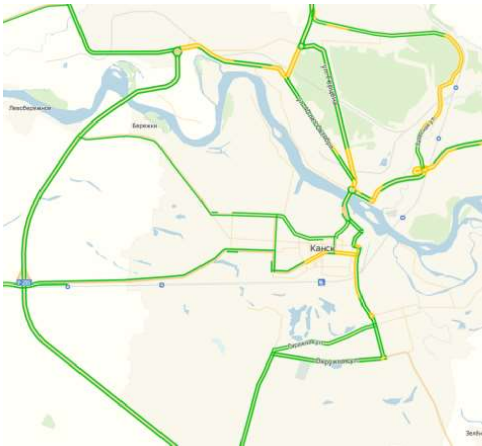
Рисунок 6.3 – Картграмма средней сетевой скорости движения транспорта на территории г. Канска в вечерний пиковый период
