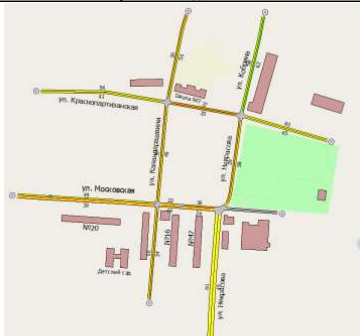
Рисунок 2.38 – Фрагмент моделирования проектной схемы ОДД узла №4 с картограммой средней скорости движения, км./ч.
